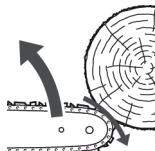
Будьте предельно внимательны и не подносите носок пильной шины до касания с предметом, это вызывает мгновенный обратный удар, при котором шина будет резко отброшена назад и вверх по направлению к оператору, в этом случае тормоз цепи автоматически активируется при
