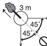
Прежде чем приступить к валке дерева определите направление его падения, учитывая расположение естественного наклона, преобладающего расположения ветвей. Учтите расположение других деревьев, строений и линий электропередач. Расчистите зону вокруг дерева.
