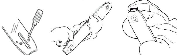
Из-за естественного износа шины на ней могут появляться заусенцы, уберите заусенцы с шины напильником, в противном случае шина будет изнашиваться интенсивней.
