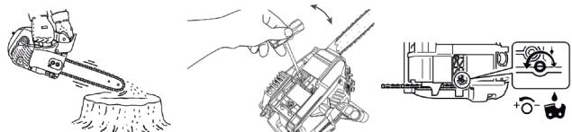
**ВНИМАНИЕ!** Регулировочный винт подачи масла поворачивается на  $\frac{1}{2}$  оборота, не прилагайте большое усилие во время регулировки, возможно повреждение масляного насоса. Данное повреждение не подлежит гарантии.
