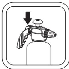
3. Настройте рассеивающую гайку, вращая ее вокруг своей оси. Для начала опрыскивания нажмите клавишу.
