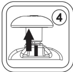
4. После завершения работы выпустите остаточное давление, потянув за шток предохранительного клапана.
