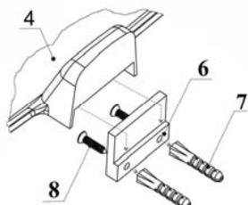
рис.3 Крепление мыльницы
