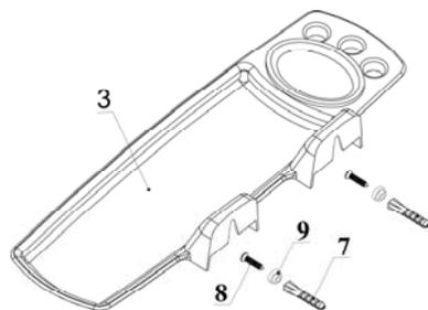
рис. 2 Крепление полки
